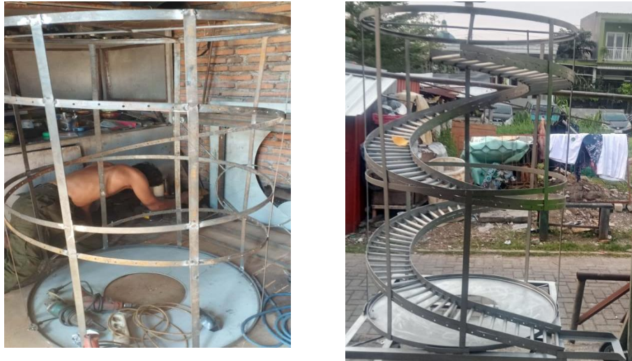
Gambar 4.3 Proses fabrikasi kerangka tabung dan spiral
