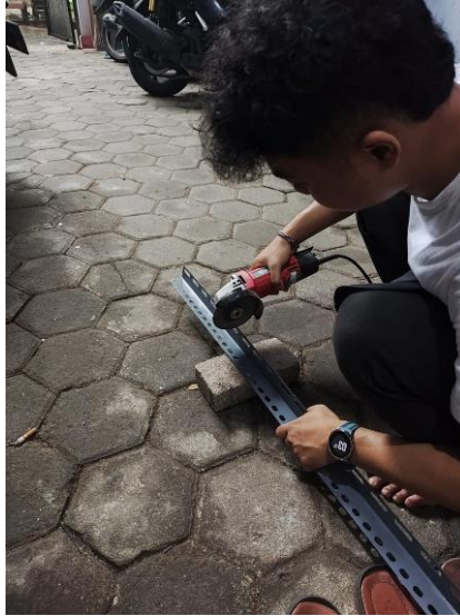
Gambar 3. 3 Pemotongan besi siku dengan gerinda
