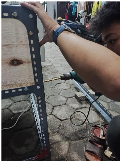
Gambar 3. 4 Melubangi besi siku dan triplek dengan bor
