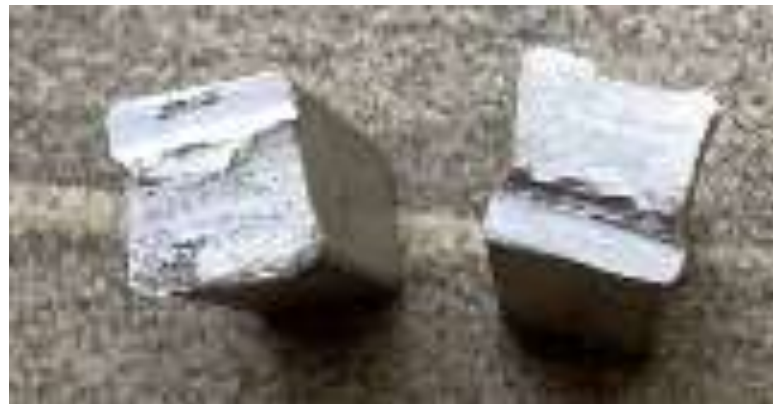
Gambar 4. 11 Patahan alumunium tampak depan
