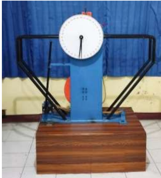
Gambar 4. 2 Alat impact setelah di modifikasi
