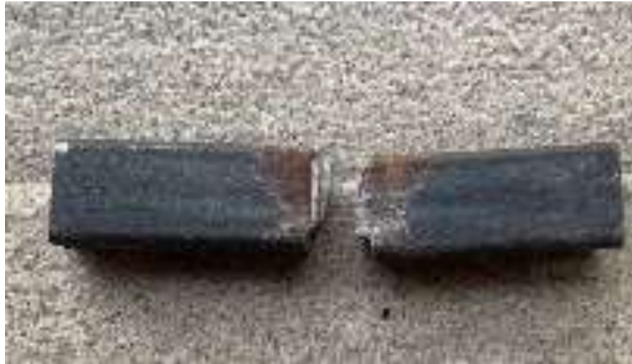
Gambar 4. 4 Patahan baja ST-37 tampak atas
