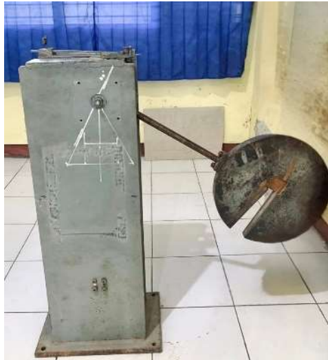
Gambar 4. 1 Alat impact sebelum di modifikasi
