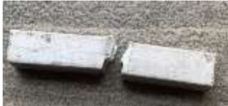
Gambar 4. 10 Patahan alumunium tampak atas
