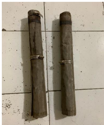
Gambar 3. 17 Wadah spesimen silindris dengan selimut wire mesh
