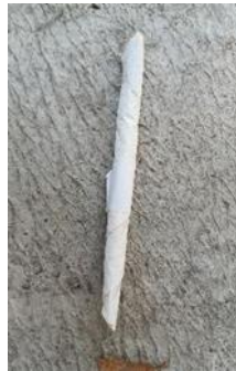
Gambar 3. 18 Persiapan serat batang pisang yang dibungkus kertas saring untuk perlakuan steaming
