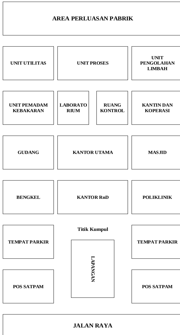
Gambar 2.2 Denah Tata Letak Pabrik Furfural
