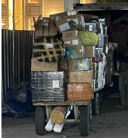
Gambar 4. 8 Muatan Melebihi Kapasitas Gerobak
