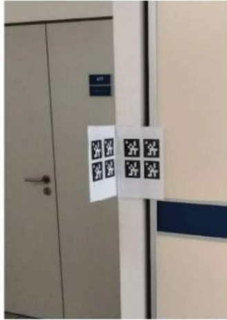
Gambar 2. 10 Titik referensi ArUco marker
