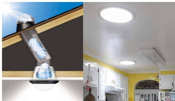
Gambar 11 detail light tube & tampak dari dalam ruang
