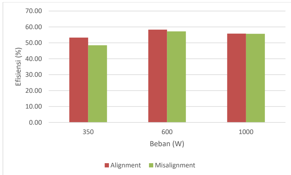
Gambar 4. 9 Diagram nilai efisiensi daya motor-generator
