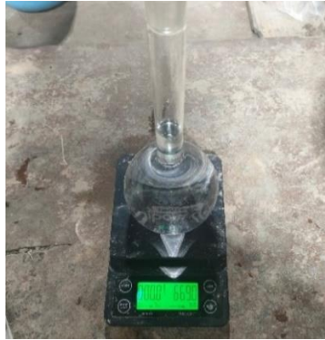
Gambar 3. 17 Menimbang Piknometer dengan Aquades
