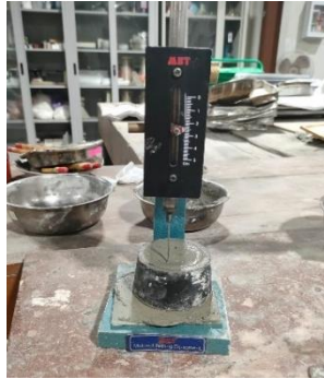
Gambar 3. 28 Membaca Hasil penurunan Setiap 15 Menit
