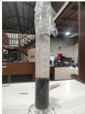
Gambar 3. 7 Diamkan Gelas Ukur 24 Jam
