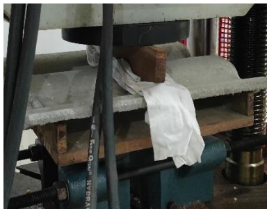
Gambar 3. 68 Meletakkan Lap di Atas Genteng
