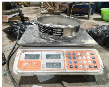
Gambar 3. 11 Menimbang Pasir Pada Setiap Saringan
