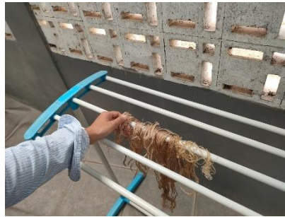
Gambar 3. 30 Jemur Serat Batang Pisang
