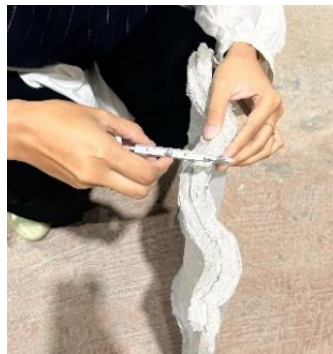
Gambar 3. 70 Mengukur Tebal, Kaitan, dan Penampang Genteng Beton
