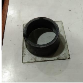
Gambar 3. 20 Menyiapkan Mol atau Cincin Ebonate
