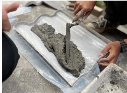
Gambar 3. 55 Mencetak Genteng Beton
