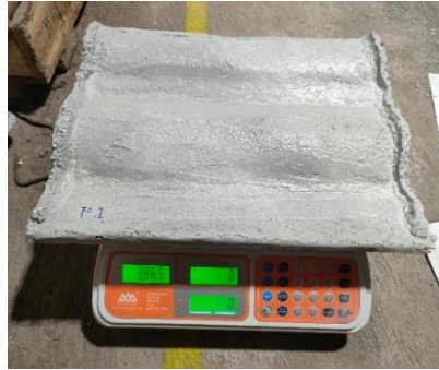
Gambar 3. 58 Menimbang Genteng Beton
