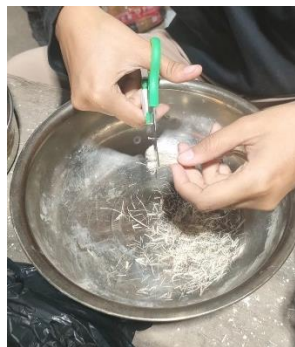
Gambar 3. 31 Potong Serat Batang Pisang Kering
