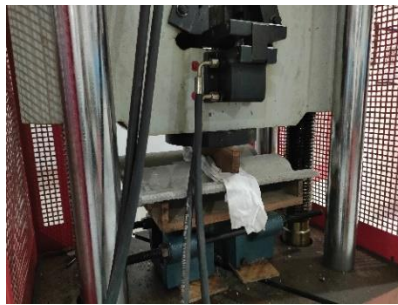
Gambar 3. 67 Meletakkan Genteng di Atas Mal Kayu
