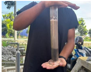
Gambar 3. 6 Mengguncangkan Gelas Ukur
