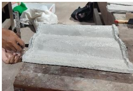
Gambar 3. 59 Mengukur Kerataan Genteng
