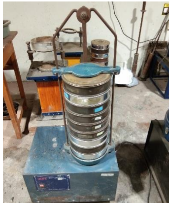
Gambar 3. 10 Menggetarkan Alat Selama 15 Menit
