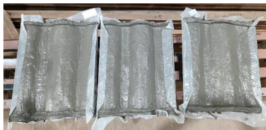
Gambar 3. 56 Mengeringkan Genteng di Suhu Ruangan
