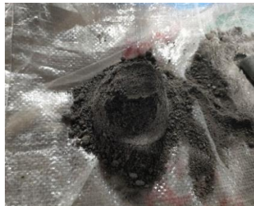
Gambar 3. 15 Angkat Metal Sand Cone
