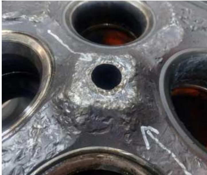
Gambar 2.5 Keretakan pada Cylinder Head Sumber: Dokumentasi Pribadi
