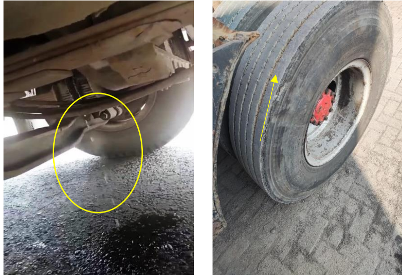
Gambar 4. 3 Oli Tumpah dan Ban Tidak Layak pada Kondisi Trailer
