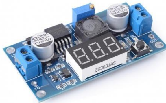
Gambar 2.8 Modul Transformator Step-Down sebagai penurun tegangan dari PSU
