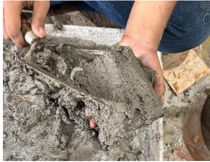
Gambar 3. 42 Melapisi Benda Uji Dengan Mortar
