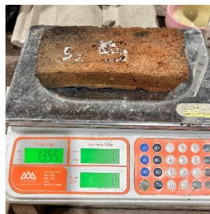
Gambar 3. 48 Menimbang Berat Basah Benda Uji
