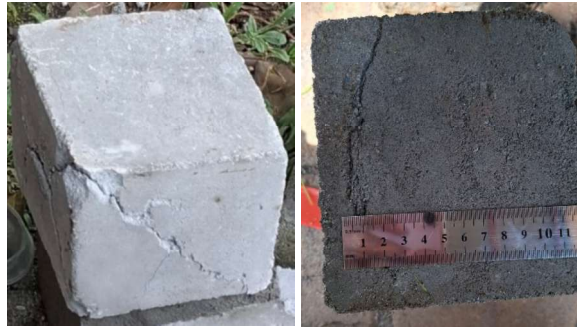
Gambar 4. 2 Retak Batako Normal
