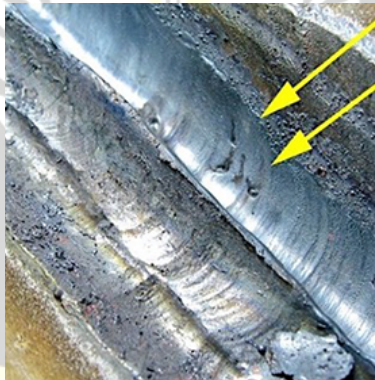
Gambar 2. 4 Cacat logam inklusi terak
