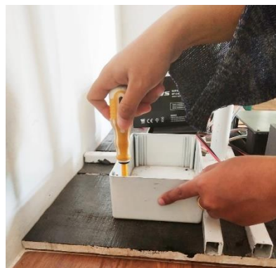
Gambar 4. 6 Perakitan Box komponen, AKI, dan SCC
