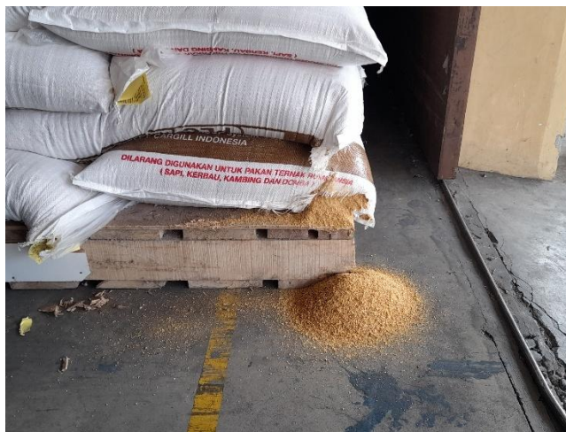
Gambar 4.6 Produk Yang Terkena Manuver Forklift
