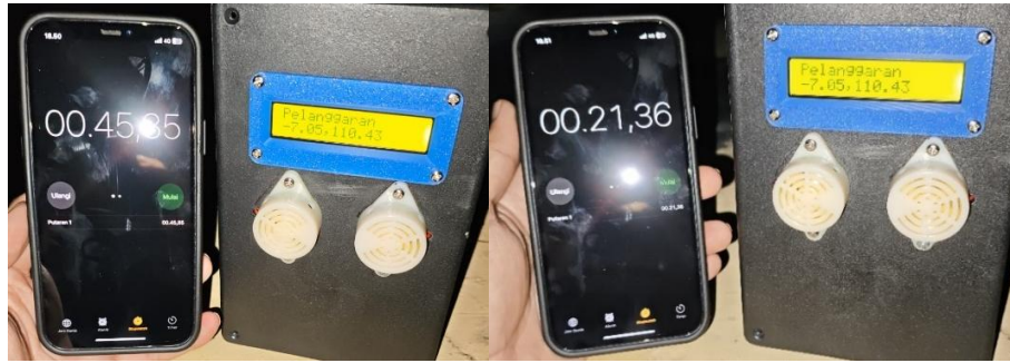
Gambar 4. 2 Pengambilan Data Waktu Inisiasi Modul GPS Neo-6M
