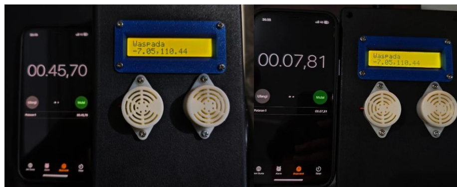
Gambar 4. 3 Pengambilan Data Waktu Inisiasi Modul GPS Neo-M8N
