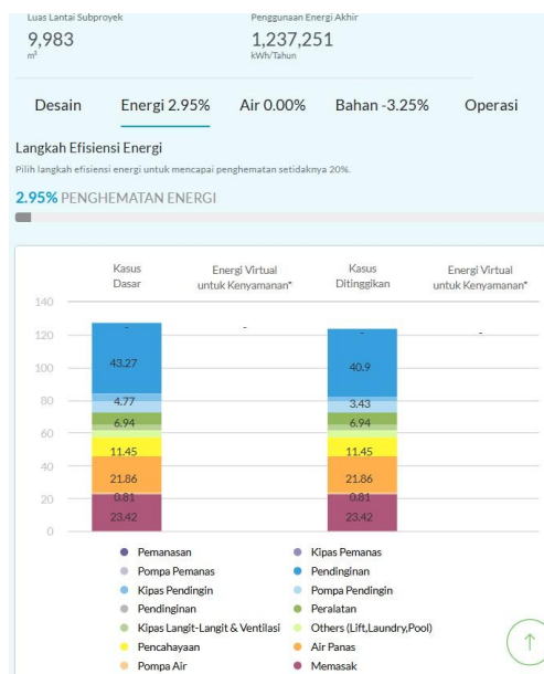
Gambar IV.74 Hasil Simulasi Energi Bangunan Redesain Perforated Panel pada EDGE APP
