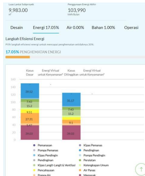
Gambar IV.39 Hasil Simulasi Energi Bangunan Redesain Fin Vertical pada EDGE APP
