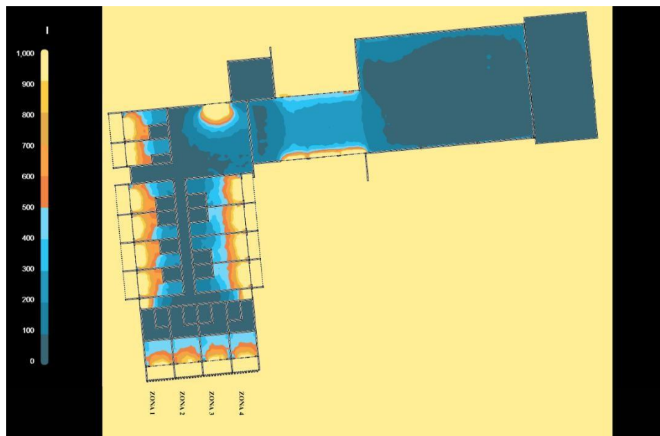
Gambar IV.58 Hasil Simulasi Fasad Fin Vertical Lantai 6 Pukul 12.00
