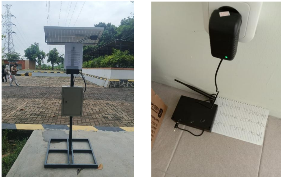
Gambar 5. 1 Skema Penempatan Alat Transmitter dan Receiver
