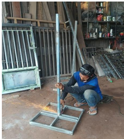
Gambar 4. 7 Proses Menggerindra Besi
