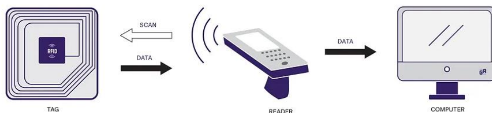
Gambar 2.14 Cara Kerja RFID
