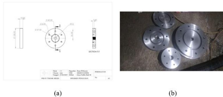
Gambar 4. 7 (a) Desain jig hidrostatik, (b) Hasil jadi jig pengujian hidrostatik
