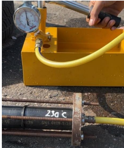
Gambar 4. 11 Proses pengujian hidrostatik pada suhu 230°C
