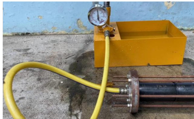
Gambar 4. 10 Proses pengujian hidrostatik pada suhu 210°C
