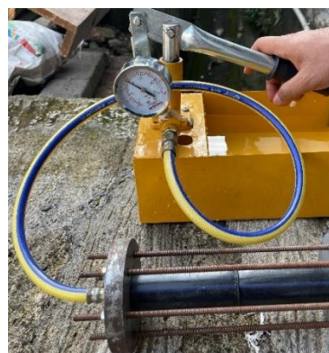
Gambar 4. 8 Proses pengambilan data pengujian hidrostatik
