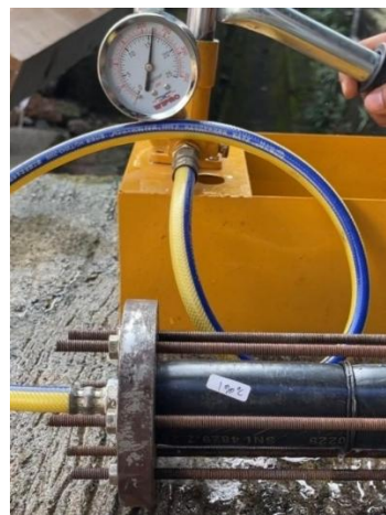
Gambar 4. 9 Proses pengujian hidrostatik pada suhu 190°C
