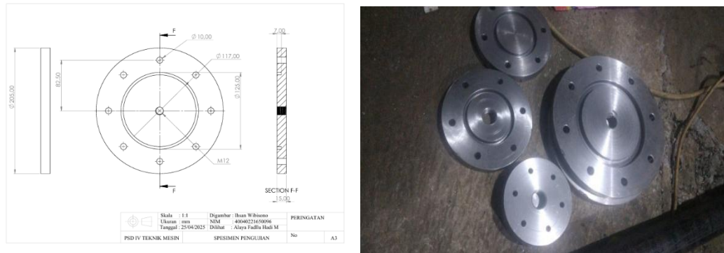
Gambar 4. 7 (a) Desain jig hidrostatik, (b) Hasil jadi jig pengujian hidrostatik
