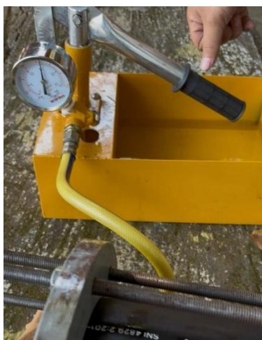
Gambar 4. 9 Proses pengujian hidrostatik pada suhu 190°C
