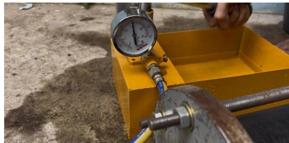
Gambar 4. 10 Proses pengujian hidrostatik pada suhu 210°C
