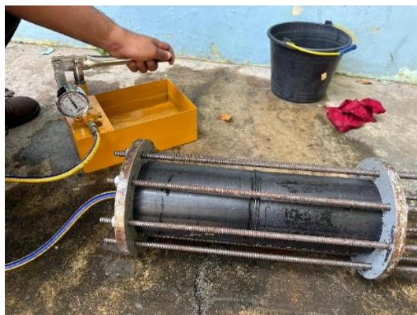
Gambar 4. 8 Proses pengambilan data pengujian hidrostatik
