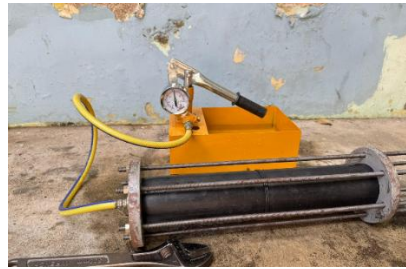
Gambar 4. 11 Proses pengujian hidrostatik pada suhu 230°C
