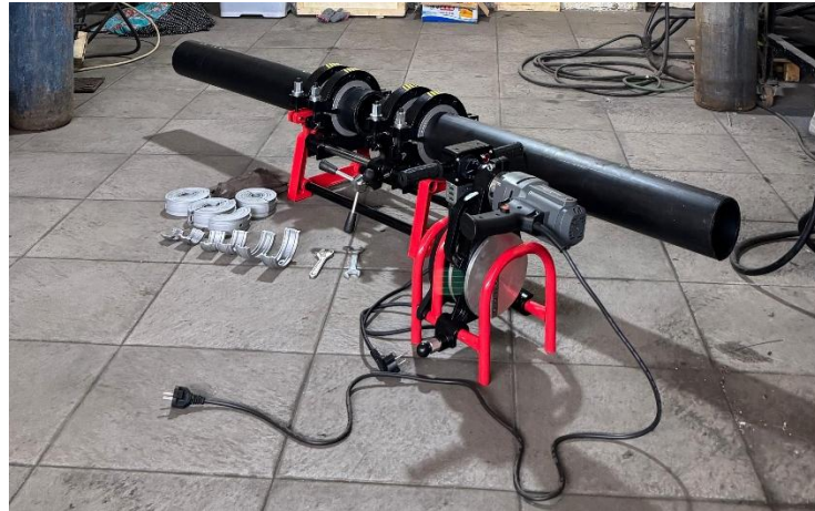
Gambar 4. 1 Proses percobaan mesin las manual butt fusion
