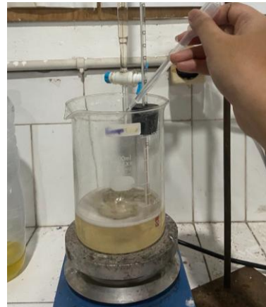
Penetesan silika dan alumina pada template CTAB dan gelatin
