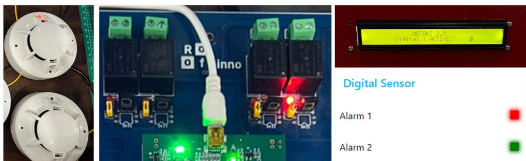
Gambar 4.29 a.) Sensor Digital 1 Aktif b.) Relay 4 ON c.) Tampilan LCD d.) Tampilan Dashboard
