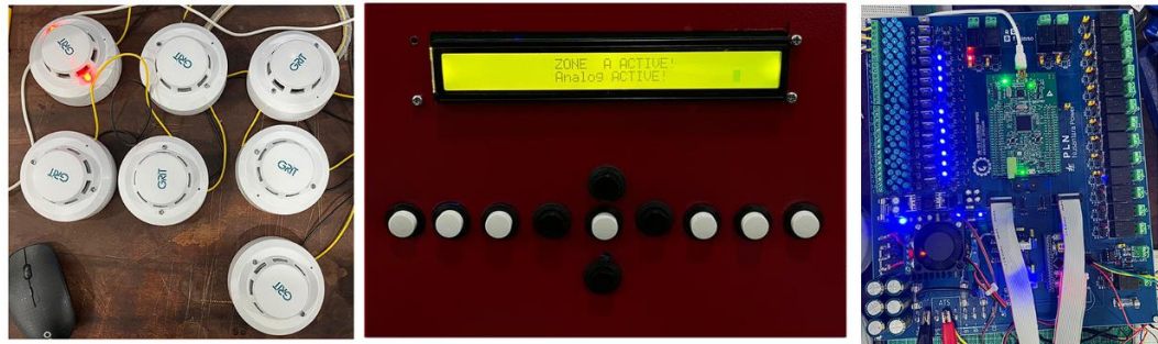
Gambar 4.27 a.) Sensor Segmen 1 Deteksi Asap b.) Tampilan LCD c.) Relay 1 ON
