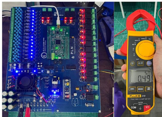
Gambar 4.4 Modul Board FACP ketika posisi HIGH tanpa beban input dan output
