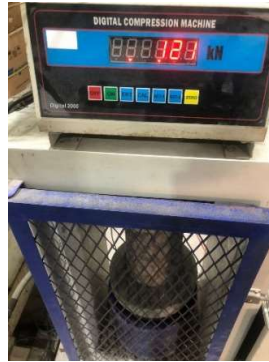
Gambar 3. 73 Pengujian kuat tekan
