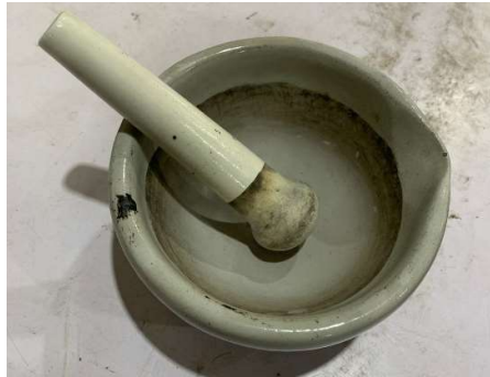
Gambar 3. 23 Mortar dan Stamper
