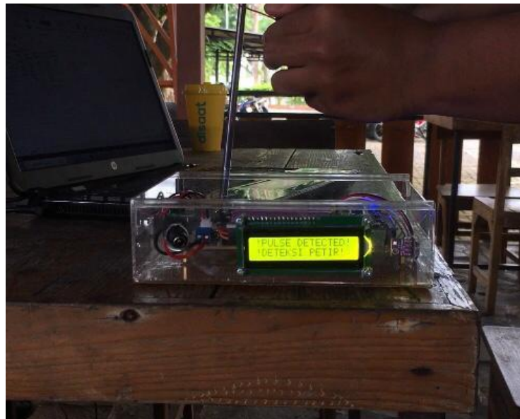
Gambar 5. 3 Tampilan LCD saat sistem mendeteksi simulasi petir
