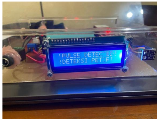
Gambar 5. 8 Tampilan LCD saat sistem mendeteksi percikan (simulasi petir)
