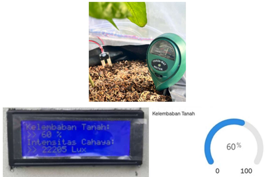
Gambar 5. 3 Kondisi Pengujian Sensor Kelembaban Tanah
