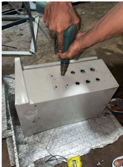
Gambar 4. 5 Membolongi Sisi Samping Panel Box Untuk Konektor GX - 16
