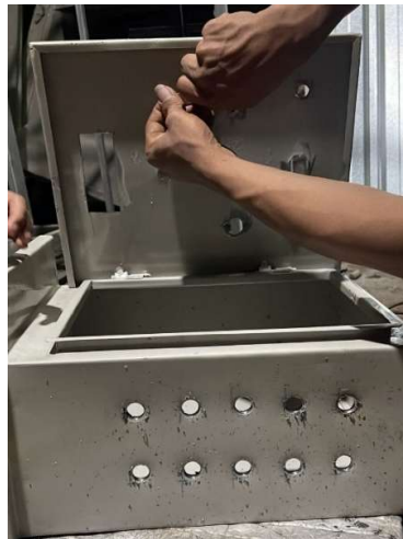
Gambar 4. 6 Pembolongan Panel Box untuk Komponen Alat Tugas Akhir
