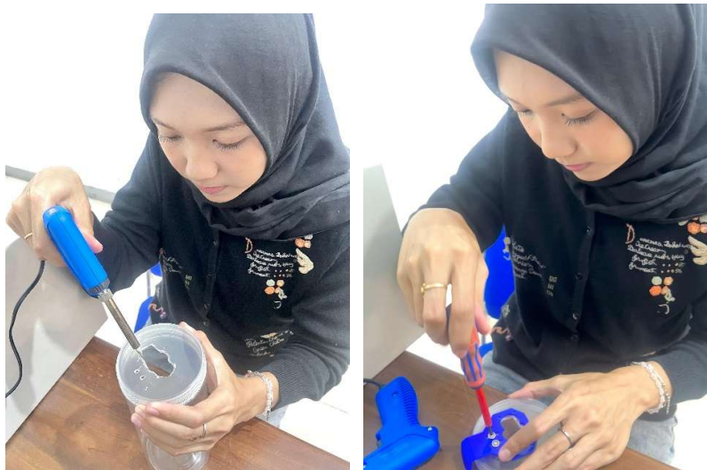
Gambar 4. 14 Melubangi dan Pemasangan Bracket Sensor HC-SR04T
