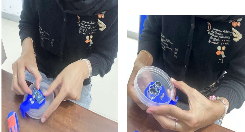
Gambar 4.15 Pemasangan Sensor ke Bracket
