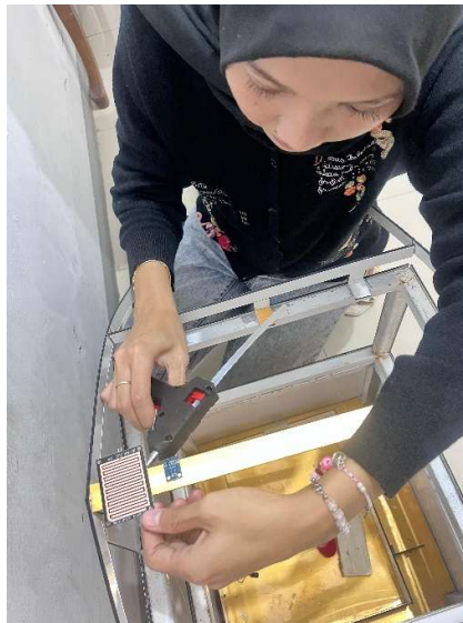
Gambar 4. 17 Pemasangan Sensor Hujan
