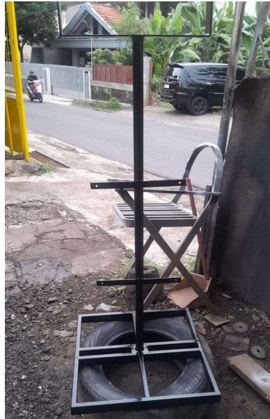
Gambar 4. 4 Penyangga Panel Box & Panel Surya
