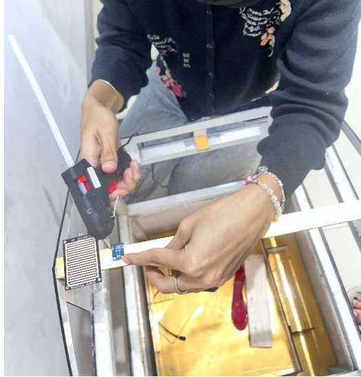
Gambar 4. 18 Pemasangan Sensor BH 1750
