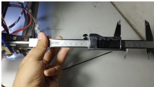
Gambar 5. 1 Proses Pengukuran Akurasi Pergerakan Sumbu CNC
