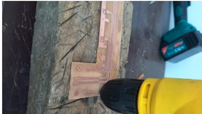
Gambar 4-12 Pembuatan Lubang Pada PCB
