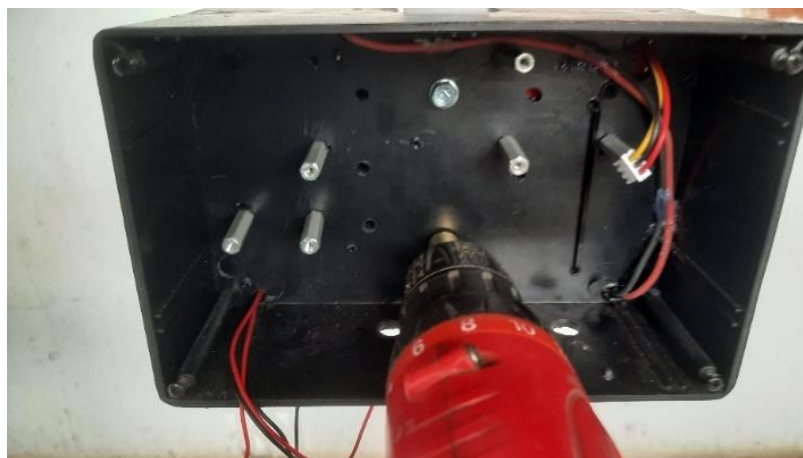
Gambar 4-2 Pemasangan Box Komponen Pada Rangka
