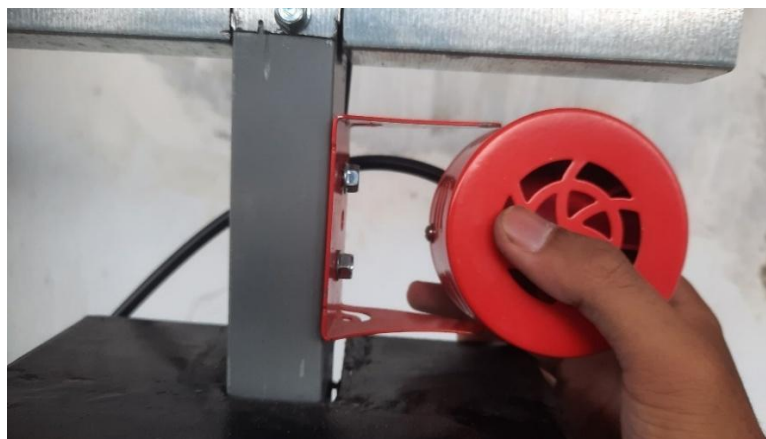
Gambar 4-5 Pemasangan Sirine Pada Rangka
