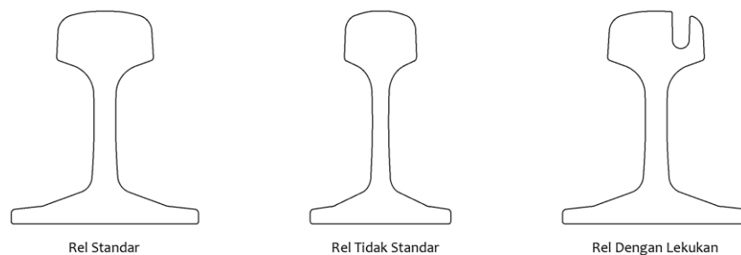
Gambar 2.20 Tipe Rel untuk jalan KA (Esveld, 2001)
