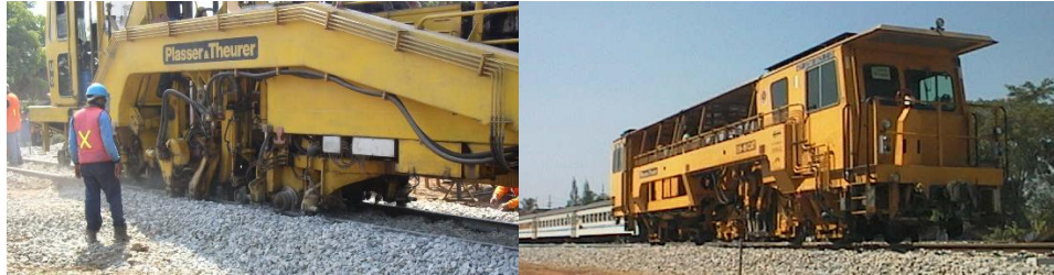
Gambar 2.4 Mesin untuk merawat jalan rel tipe Plasser Theurer 09- 32 CSM Sumber: dokumentasi penulis
