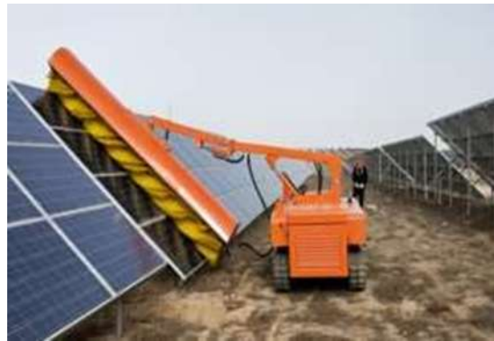
Gambar 2. 8 Robot Ekskavator dengan Sikat Rol Panjang
