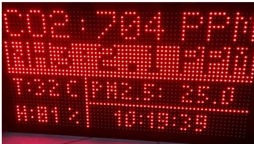
Gambar 5. 2 Tampilan DMD P10 ketika Parameter Melebihi Ambang Batas
