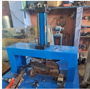
Gambar 3. 26 Pemasangan Silinder dan Pompa
