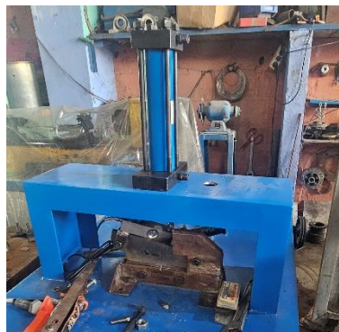
Gambar 3.26 Pemasangan silinder dan pompa
