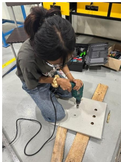
Gambar 4. 1 Pelubangan Box Panel
