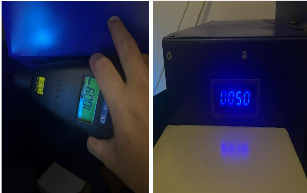
Gambar 4. 10 Pengukuran kecepatan pulley 1 dan pulley 2
