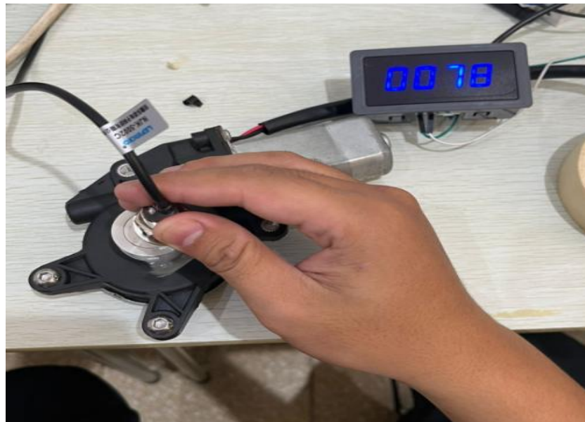
Gambar 4. 8 Pengujian komponen Motor DC Power Window
