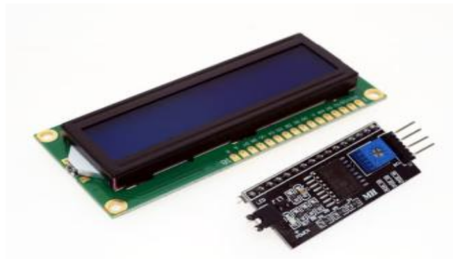
Gambar 2. 15 Komponen LCD yang dilengkapi modul I2C digunakan untuk menyederhanakan koneksi pin pada LCD.
