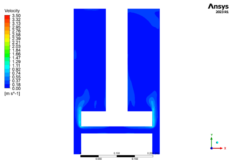
Gambar 4.8 Kontur distribusi kecepatan fluida kondisi eksisting.
