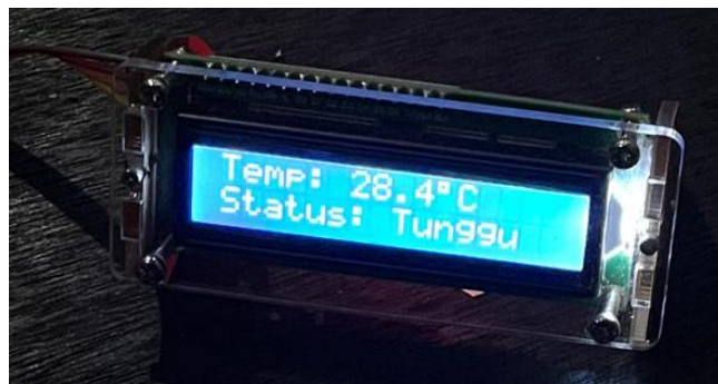
Gambar 4.1 Hasil Pengujian LCD 16x2
