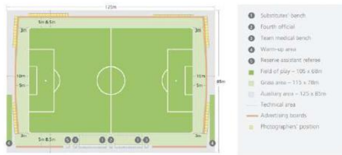
Gambar 2. 4 Tinjauan Detail Area Lapangan Ideal Stadion
