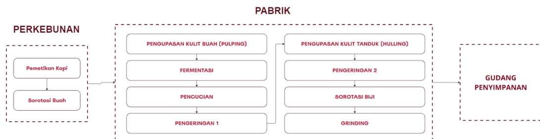
Gambar 2.2 Skema Proses Produksi Kopi
