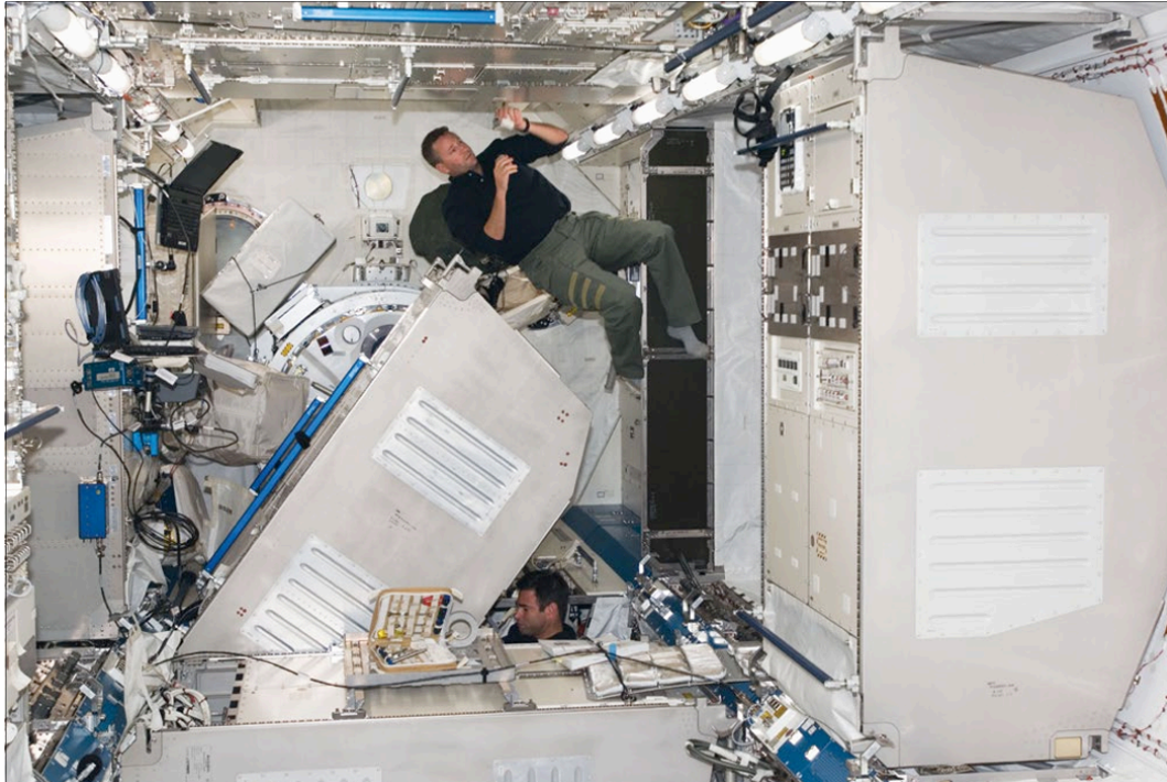
Gambar 3. 5 Contoh rak standar yang dipasang di Modul Eksperimen Jepang. Rak diputar sebagian ke tempatnya pada titik porosnya sementara seorang astronot bekerja pada sambungan di belakangnya. Di sebelah kanan gambar adalah rak yang sudah terpasang penuh.
