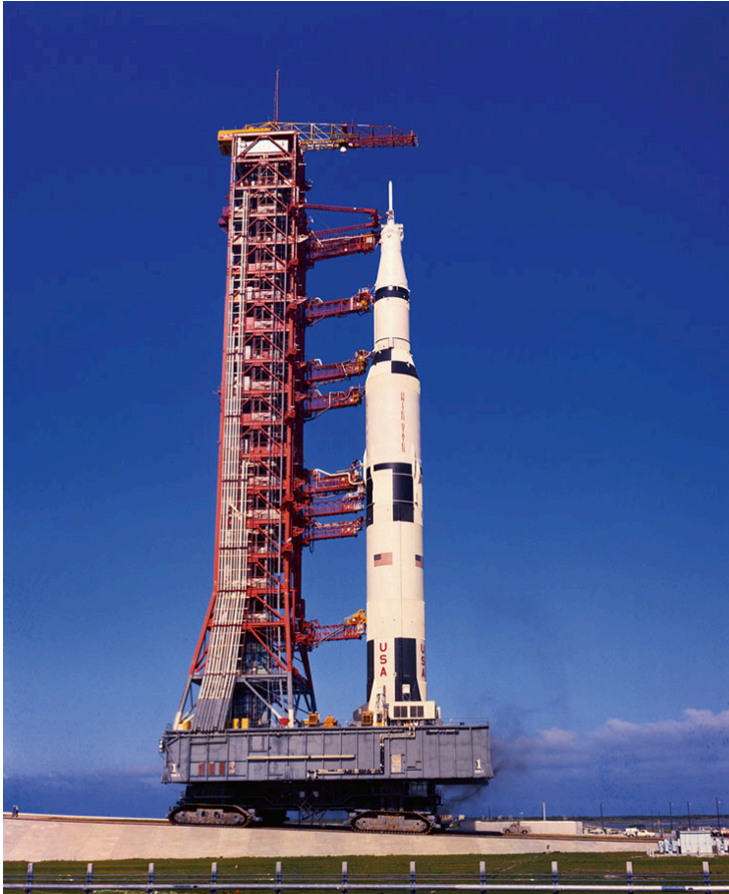
Gambar 3. 19 Crawler Transporter mulai mendaki tanjakan menuju pad A dengan LUT 1 dan kendaraan antariksa Apollo 11.
