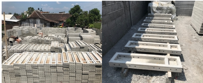
Gambar II.2 Produksi Panel Struktural RUSPIN di workshop RUSPIN Jawa Tengah Sumber : Dokumentasi Pribadi
