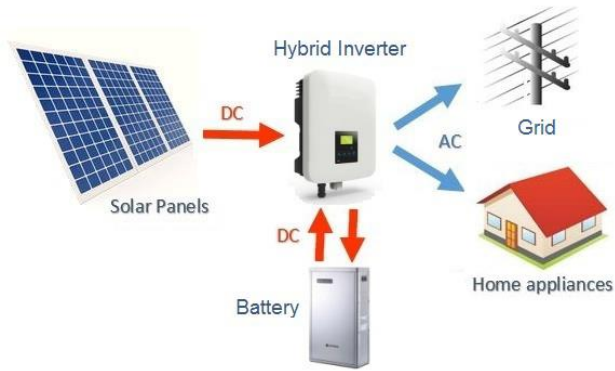
Gambar 2.6 Skema PLTS Hybrid (sumber: www.builder.id )
