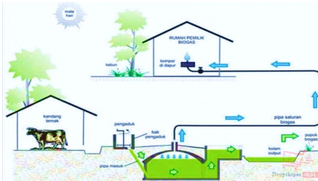
Gambar 2.2. Pengolahan biogas dari limbah kotoran sapi (Dropshiper, 2020)
